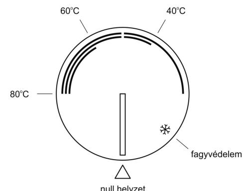
ohřívač vody při teplotě nastavené na 60°C a teplotu nastavujte do pozice 80°C pouze v nutném případě. Při nastavení na 40°C i na 60°C významně klesá usazování vodního kamene a riziko koroze.
