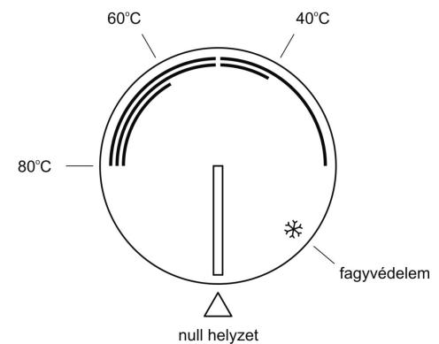
die 80°C-Stellung. Sowohl in der 40°C als auch in der 60°C-Stellung sinkt die Kalkablagerung und die Korrosion beträchtlich.
