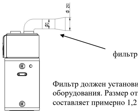
Фильтр должен установить пользователь оборудования. Размер отверстий сетки составляет примерно 1,2 мм.
