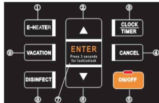
Remarque : L'activation de tout bouton peut être réalisé à condition que la fermeture du clavier soit débloquée sur l'interface de commande.
