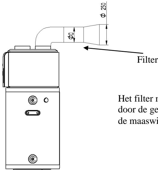
Het filter moet worden gemonteerd door de gebruiker van het apparaat, de maaswijdte is ongeveer 1,2 mm.
