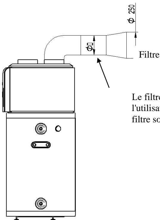
Le filtre doit être monté par l'utilisateur, les trous du tamis du filtre sont d'environ 1,2 mm.
