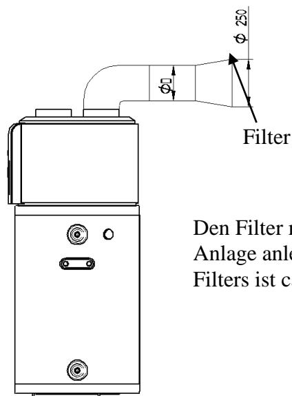
Den Filter muss der Benutzer der Anlage anlegen, Lückengröße des Filters ist ca. 1.2 mm.
