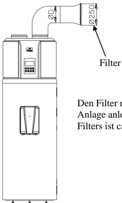
Den Filter muss der Benutzer der Anlage anlegen, Lückengröße des Filters ist ca. 1.2 mm.
