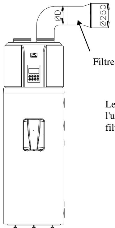
Le filtre doit être monté par l'utilisateur, les trous du tamis du filtre sont d'environ 1,2 mm.
