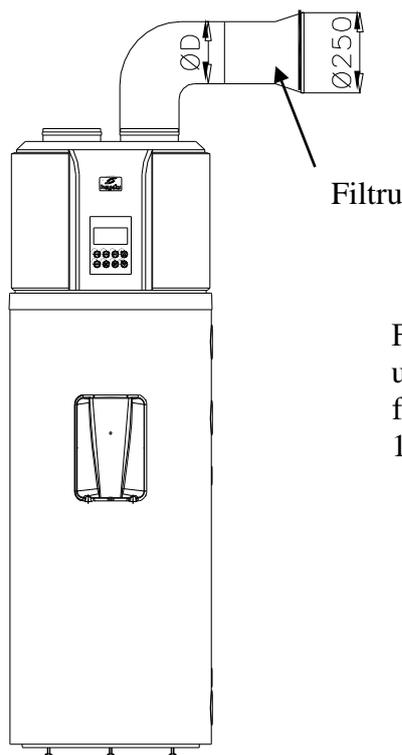
Filtrul trebuie montat de către utilizatorul echipamentului, plasa de filtru trebuie să aibă găuri de cca. 1.2mm.
