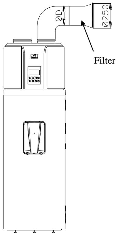
Het filter moet worden gemonteerd door de gebruiker van het apparaat, de maaswijdte is ongeveer 1,2 mm.
